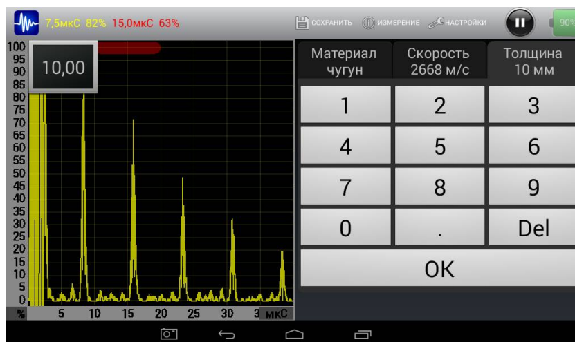
Рис. 20. Калибровка с заданием известной толщины объекта контроля
