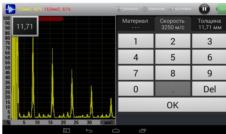
Рис. 21. Калибровка с заданием скорости звука
